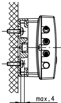
Abb. 5: Maximal zulässige Schraubenkopfhöhe (bei Verwendung der Wandhalterung)
