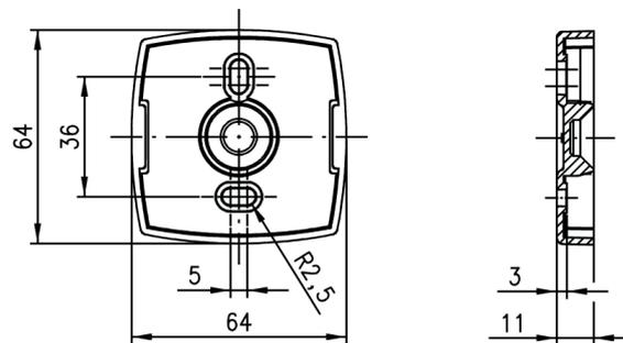
Abb. 4: Draufsicht und Querschnitt von der Adapterplatte
